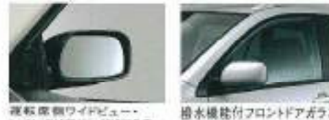
運転席側ワイドビュー・レインクリアリングドアミラー
