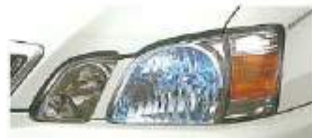
ディスチャージヘッドランプ（ロービーム・レベリング機能付）
