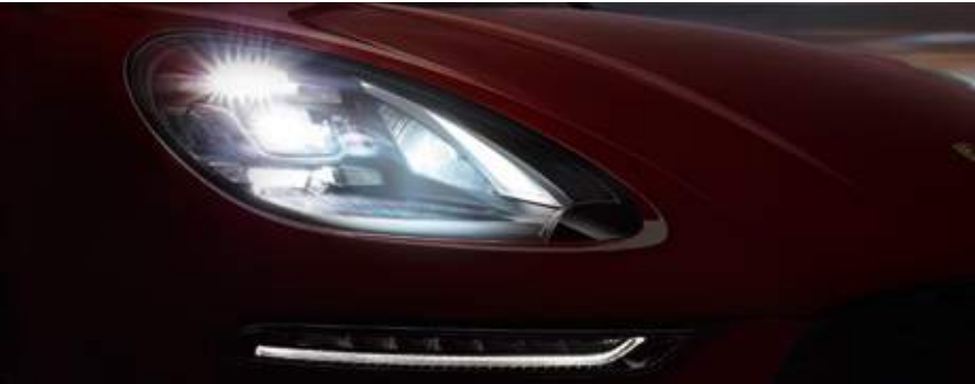
Abblendlicht und Kurvenlicht mit LED-Hauptscheinwerfer
