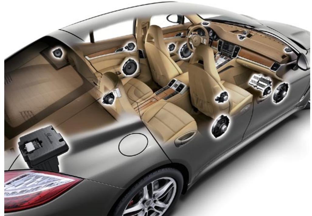
Speziell für den Panamera wurden Bändchen-Hochtöner (Air Motion Transformer, AMT) eingesetzt. Für unverkennbar feine, klare und unverzerrte, pegelfeste Hochtonwiedergabe. Alle Lautsprecherchassis sind exakt aufeinander abgestimmt und liefern ein Höchstmaß an Bassfundament, Auflösung und Impulsgenauigkeit.
