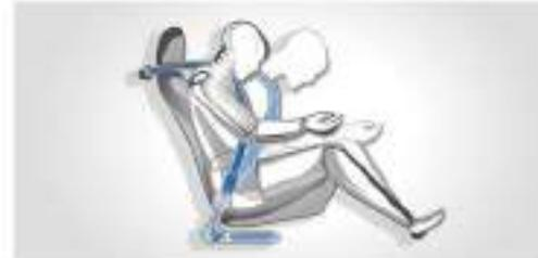
■ **BMW Rückhaltesystem** für Fahrer und Beifahrer besteht aus einer Kombination von 3-Punkt-Sicherheitsgurt, Gurtstrammer und Gurtkraftbegrenzer. So ist für bestmögliche Rückhaltewirkung bei einer Kollision gesorgt. Um ein Fälschangurten im Fond zu vermeiden, sind die Gurtschlösser kodiert.
