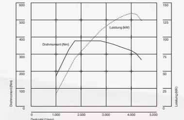
Beindruckend drehmomentstark: der BMW TwinPower Turbo 4-Zylinder Dieselmotor in der BMW 320d Limousine.
