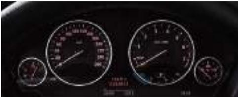
■ **Instrumentenkombination** mit vier Analoginstrumenten für Geschwindigkeit, Drehzahl, Tankinhalt, Öltemperatur sowie ein Info Display. Hier werden z. B. Außentemperatur und Bordcomputerfunktionen angezeigt.
