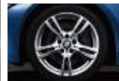
■ 18" M Leichtmetallräder Doppelspeiche 400 M mit Notlauf-eigenschaften und Mischbereifung, vorn 8 J x 18, Bereifung 225/45 R 18, hinten 8,5 J x 18, Bereifung 255/40 R 18.
