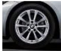
□ 17" Leichtmetallräder V-Speiche 395 mit Mischbereifung, vorn 7,5 J x 17, Bereifung 225/50 R 17, hinten 8,5 J x 17, Bereifung 255/45 R 17.
