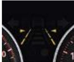
□ **Spurverlassenswarnung** inkl. kamerabasierter Auffahrwarnung erkennt mithilfe einer Kamera bereits das Annähern an eine Fahrbahnmarkierung und warnt den Fahrer sofort per Vibration am Lenkrad (nur in Verbindung mit Instrumentenkombination mit erweiterten Umfängen).
