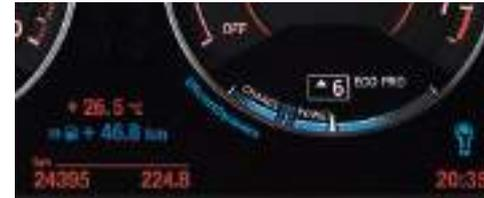
■ **Schaltpunktanzeige** zeigt an, wenn Sie in einem anderen Gang verbrauchsgünstiger fahren würden (in Verbindung mit dem manuellen 6-Gang Getriebe und Steptronic Getriebe).
