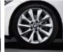
□ 18" Leichtmetallräder Turbinenstyling 415, 8 J x 18, Bereifung 225/45 R 18 (nur erhältlich in Verbindung mit Modern Line, Serie für 328i, 335i, 325d, 330d und 335d xDrive).
