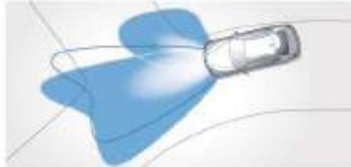
□ **Adaptives Kurvenlicht mit variabler Lichtverteilung**, inkl. Abbiege-licht und BMW Selective Beam (blendfreier Fernlichtassistent), leuchtet Kurven in größerer Entfernung durch die beweglichen Scheinwerfer optimal aus, sobald der Fahrer in sie einlenkt. Das in die Nebelscheinwerfer integrierte Abbiege-licht zur Verbesserung des Nahsichtbereichs wird bereits im Stand bei Betätigung des Blinkers oder per Lenkeinschlag automatisch aktiviert.
