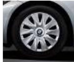
■ 16" Stahlräder mit Radvollblende, 7 J x 16, Bereifung 205/60 R 16 (Serie für 316i, 316d und 318d).
