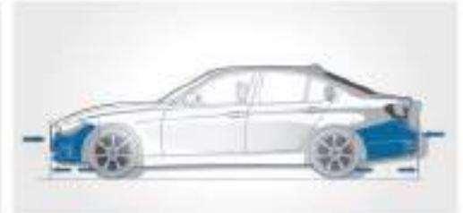
■ **Stoßfängersystem** vorn und hinten verfügt über auswechselbare Verformungselemente, die Kräfte bis zu einer Geschwindigkeit von 15 km/h aufnehmen.
