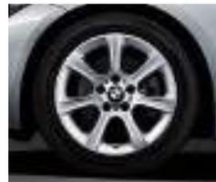
□ 17" Leichtmetallräder Sternspeiche 394, 7,5 J x 17, Bereifung 225/50 R 17 (Serie für 328i, 335i, 325d, 330d und 335d xDrive).
