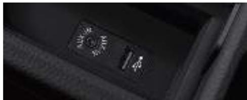
■ **Freisprecheinrichtung mit USB-Schnittstelle** ermöglicht die drahtlose Verbindung geeigneter Bluetooth-Handys mit dem Fahrzeug. Über die integrierte USB-Schnittstelle lassen sich geeignete Audioquellen, z. B. MP3-Player, iPod oder USB-Stick, anschließen.
