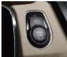
■ **Auto Start Stop Funktion** schaltet den Motor bei kurzzeitigem Fahrzeugstopp vorübergehend ab, z. B. an der Ampel, und reduziert dadurch den Kraftstoffverbrauch. Eine Anzeige im Drehzahlmesser signalisiert, dass die Funktion aktiv ist.
