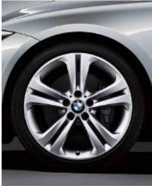
□ 19" Leichtmetallräder Doppelspeiche 401 mit Mischbereifung, vorn 8 J x 19, Bereifung 225/40 R 19, hinten 8,5 J x 19, Bereifung 255/35 R 19.
