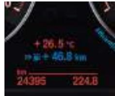
■ **Bordcomputer** informiert über Durchschnittsgeschwindigkeit, Durchschnitts- und Momentanverbrauch, Reichweite und Außentemperatur. Bei eingeschaltetem ECO PRO Modus wird zusätzlich die Bonusreichweite angezeigt.
