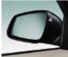
□ **Spurwechselwarnung** erkennt bei einem durch Blinkerbetätigung geplanten Spurwechsel ein Fahrzeug im toten Winkel bzw. ein sich auf der Überholspur mit hoher Geschwindigkeit näherndes Fahrzeug und warnt den Fahrer per Vibration am Lenkrad sowie durch ein optisches Signal im Außenspiegelgehäuse.
