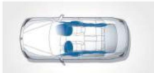
■ **Airbags** sind Teil der optimal aufeinander abgestimmten Sicherheitskomponenten in einem BMW. Sechs Airbags bieten gezielten Schutz: Fahrer- und Beifahrerairbag, die Kopfairbags (Curtain) für vorn und hinten sowie die in den Vordersitzlehnen integrierten Seitenairbags.
