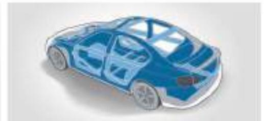
■ **Fahrgastzelle** bietet durch die funktional ausgelegte Struktur mit speziellen Trägerverläufen und Knotenanbindungen sowie den gezielten Einsatz von hochfesten Materialien ein Optimum an passiver Sicherheit im Falle eines Front-, Seiten- und Heckcrashes. Diese Karosseriestruktur kann durch definierte Verformungszonen Aufprallenergie aufnehmen und trägt so zum Schutz der Insassen bei.
