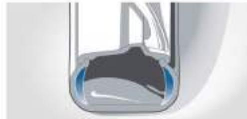
□ **Reifen mit Notlaufeigenschaften** sorgen durch verstärkte Flanken dafür, dass die Reifen selbst ohne Luftdruck nicht völlig einsinken und von der Felge springen können (Serie ab 17" Leichtmetallrädern). So gelangen Sie sicher zur nächsten Werkstatt.
