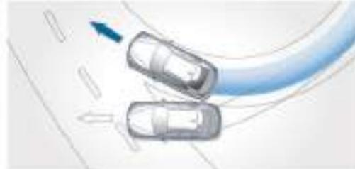
■ **Dynamische Stabilitäts Control (DSC)**, inkl. Cornering Brake Control (CBC), Anfahr- und Bremsassistent, Trockenbremsen und Bremsbereitschaft. DSC erkennt eine Schleuderneigung im Ansatz und stabilisiert das Fahrzeug in Millisekunden. Die Unterfunktion Traktionsmodus (DTC) erlaubt erhöhten Radschlupf, um situationsabhängig den Vortrieb zu optimieren und sportlicheres Fahren zu ermöglichen.
