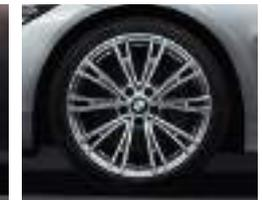
□ 19" BMW Individual Leichtmetallräder V-Speiche 626 I<sup>1</sup>, mit Mischbereifung Größe vorn 8 J x 19, Bereifung 225/40 R 19, Größe hinten 8,5 J x 19, Bereifung 255/35 R 19. Der BMW Individual Schriftzug ist dezent eingelassert.
