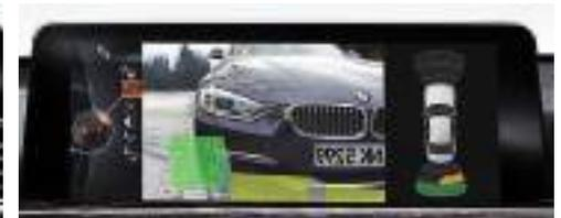
□ **Rückfahrkamera** zeigt den Bereich hinter dem Fahrzeug übersichtlich auf dem Control Display an. Die Rückfahrkamera sorgt für bessere Übersicht beim Rückwärtsfahren in Parksituationen im Geschwindigkeitsbereich von unter 20 km/h. Bei Modellen mit Anhängerkupplung verfügt die Rückfahrkamera über eine erweiterte Zoomfunktion (erhältlich in Verbindung mit Park Distance Control).
