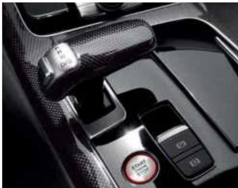
**Wählhebel in Carbon Atlas mit Shift-by-Wire-Technologie****Bedienelemente in Leder Audi exclusive**
