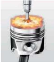
**Die Piezo-Injektoren** öffnen und schließen sich innerhalb von Millisekunden und spritzen mehrmals mit bis zu 2.000 bar Kraftstoff in den Brennraum ein. Bei einem Einspritzvorgang werden teilweise winzigste Mengen von weniger als einem tausendstel Gramm eingespritzt.
