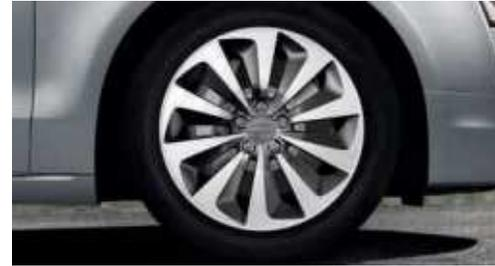
**Aluminium-Gussräder im 10-Arm-Turbinen-Design (hybrid-Design), anthrazit, teilpoliert**
