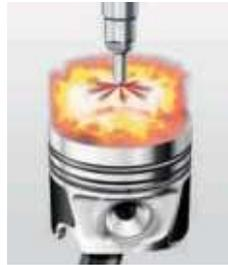
**Die Voreinspritzung** führt zu einer „weichen“ Verbrennung und damit zu einer ausgezeichneten Verbrennungakustik und einem angenehmen Motorlauf.
