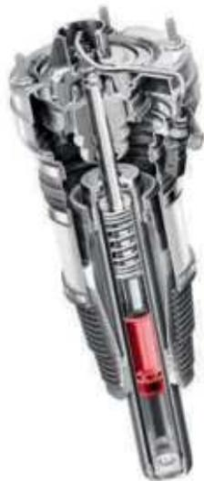
**Volltragende Luftfedern** an der Vorder- und Hinterachse verleihen dem Fahrzeug dank permanenter Niveauregelung, selbst bei voller Beladung oder im Anhängerbetrieb, stets einen hervorragenden Fahrkomfort. Der lift-Modus erhöht die Bodenfreiheit in schwierigem Terrain.
