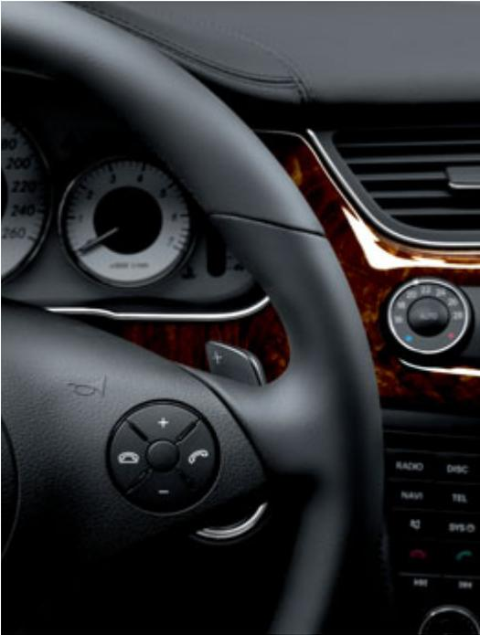
Schalt paddles ermöglichen auf Wunsch sportliche Gangwechsel direkt vom Lenkrad aus.
