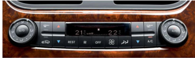
Die Komfort-Klimatisierungsautomatik THERMOTRONIC bietet darüber hinaus die Möglichkeit, die Temperatur für alle vier Insassen individuell zu regeln.
