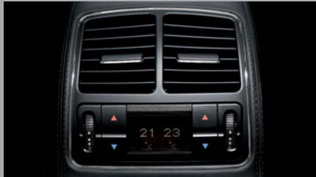
Die Komfort-Klimatisierungsautomatik THERMOTRONIC bietet die Möglichkeit, die Temperatur auch für die Insassen im Fond individuell zu regeln.
