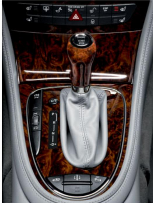
Der Start-/Stop-Knopf für das optionale KEYLESS-GO befindet sich auf dem Schaltknopf des Wählhebels.
