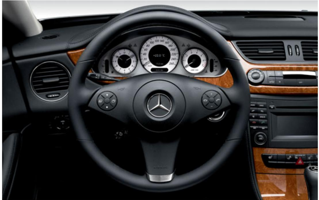
Das Multifunktionslenkrad ermöglicht die Bedienung des Telefons und verschiedener Fahrzeugfunktionen wie des Kombiinstrumentes und des Radiosystems, ohne eine Hand vom Lenkrad nehmen zu müssen.
