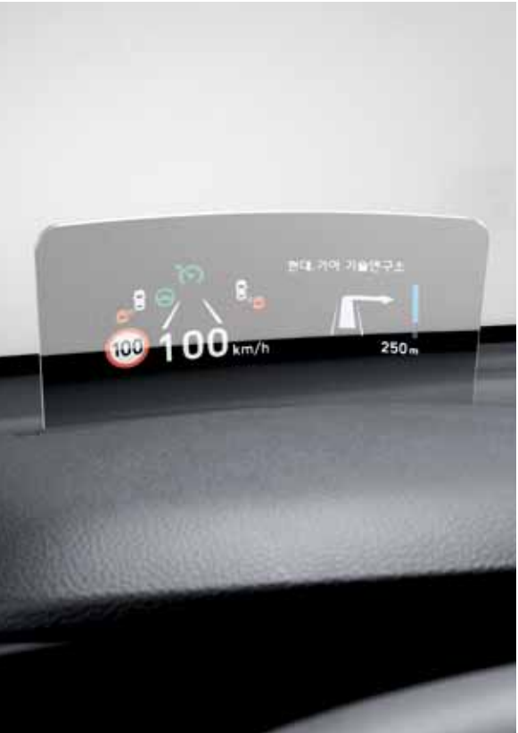
헤드업 디스플레이 운행 시 필요한 주요 주행 정보를 클러스터 앞쪽 컴바이너에 투영하여 운전자의 눈높이에 맞춰 운전 중에도 편리하게 내비게이션의 정보를 확인할 수 있습니다.
