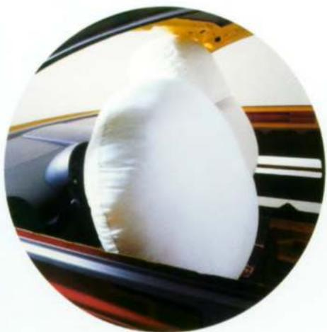
Der Fahrer- und der Beifahrerairbag sind in Sekundenbruchteilen aufgeblasen und fangen Ihren Kopf und Oberkörper sicher auf.
