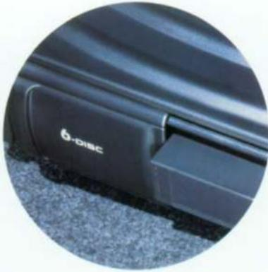
**Platz für sechs CDs:** Der CD-Wechsler im Gepäckraum läßt sich über die Radioanlage bedienen.
